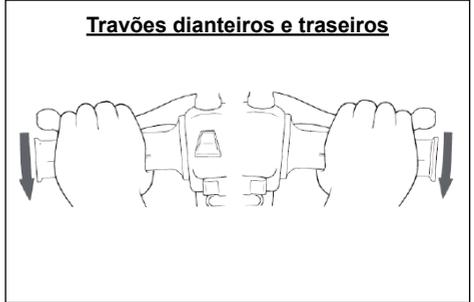
1. Puxe a manete do travão com a mão esquerda e segure o suporte de bagagem com a mão direita. Apoie-se sobre o veículo para recolher o descanso central.
