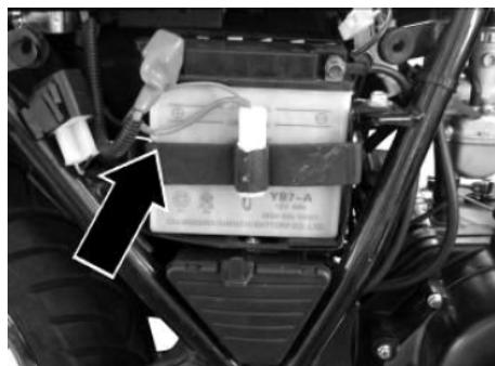
A caixa de fusíveis está localizada perto da bateria, do lado direito do chassis. Um único fusível assegura a proteção de todo o circuito elétrico. No caso de falha elétrica, verifique primeiro se o filamento não está queimado. Neste caso, substitua-o por outro fusível (15A) fornecido na caixa prevista para o efeito. Caso contrário, verifique as ligações da tampa do fusível.
