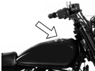
Para abrir a tampa do depósito de combustível rode a chave no sentido dos ponteiros do relógio. A tampa pode então ser removida com a chave.
