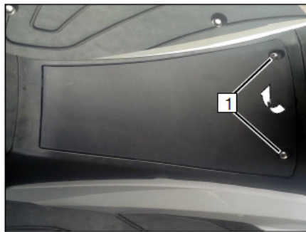
1. Retirar os parafusos (1) e a tampa da bateria
