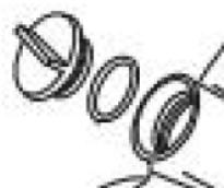
3. Remover o bujão de drenagem, na parte inferior do motor, para drenar o óleo.
