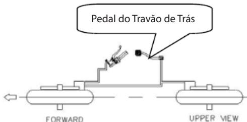
O sistema de travagem combinado (CBS) permite que quando accionar o pedal do travão traseiro, o travão traseiro e o travão dianteiro funcionem em simultâneo. Este conjunto permite ao condutor uma maior segurança. É claro que, em caso de emergência, deve ser utilizado o travão traseiro e o travão dianteiro em conjunto, de modo a garantir uma potência de travagem suficiente.
