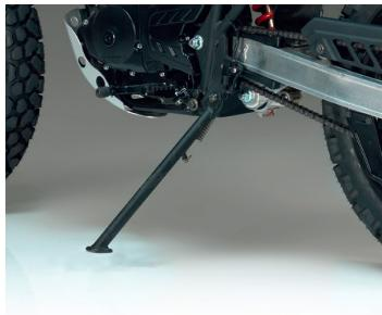
O veículo está equipado com um descanso lateral do lado esquerdo.
