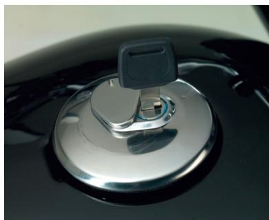
Para abrir a tampa do depósito de combustível rode a chave no sentido dos ponteiros do relógio. A tampa pode então ser removida com a chave.
