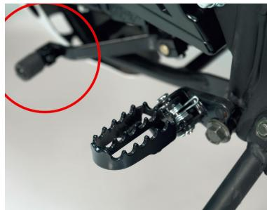
A BULLIT está equipada com uma transmissão de 5 velocidades. O pedal de mudança está ligado ao mecanismo de transmissão. Depois de engrenar uma mudança, o pedal volta à posição inicial e a próxima mudança pode ser engrenada. O ponto neutro situa-se entre a primeira e a segunda velocidade. A partir de ponto neutro, baixe o seletor de velocidades para engrenar a primeira velocidade.
