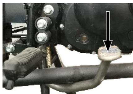
Deve pressionar este pedal para ativar o travão traseiro. A luz de travagem acende-se em simultâneo.
