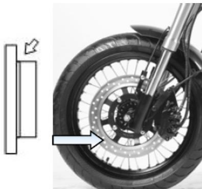
O essencial para verificar a pastilha de travão da roda dianteira é ver se a pastilha está gasta até à marca limite. Se o desgaste exceder a marca, a pastilha de travão deve ser substituída por uma nova.
