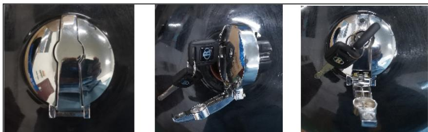
Quando a luz de aviso de combustível baixo do velocímetro estiver acesa, abasteça imediatamente. Para abrir a tampa do depósito de combustível, rodar a chave no sentido dos ponteiros do relógio. A tampa pode então ser removida com a chave.
