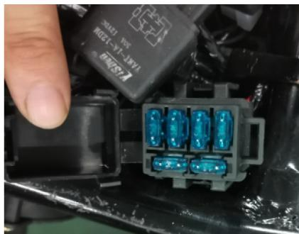
A caixa de fusíveis está localizada perto da bateria. Um único fusível assegura a proteção de todo o circuito elétrico. No caso de falha elétrica, verifique primeiro se o filamento não está queimado. Neste caso, substitua-o por outro fusível fornecido na caixa prevista para o efeito. Caso contrário, verifique as ligações da tampa do fusível.
