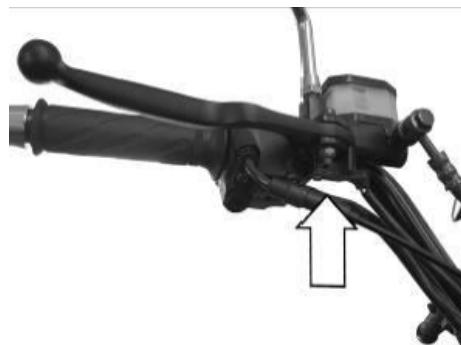
O interruptor da luz de travão dianteiro está localizado abaixo da manete de travão. Solte o parafuso e move a posição do interruptor para trás e para a frente a fim de encontrar um ponto adequado para que a lâmpada se acenda imediatamente quando é aplicada pressão, mas antes que a manete seja totalmente pressionada.
