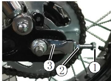
Ao ajustar a corrente, deve manter as rodas de encaixe da corrente dianteira e traseira alinhadas e centradas. Para o ajudar a fazer este ajuste há uma escala no braço oscilante e a cada ajuste da corrente a mesma pode e deve servir como referência. Depois de corresponder e ajustar o grau de inclinação da corrente para 10-20mm, apertar o parafuso do eixo traseiro e fazer a verificação final.
