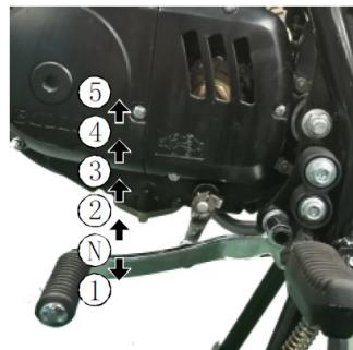
Este veículo está equipado com uma transmissão de 5 velocidades. O ponto neutro situa-se entre a primeira e a segunda velocidade. A partir de ponto neutro, baixe o seletor de mudanças para engrenar a primeira velocidade.
