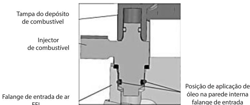
C: Após a desmontagem e aquando da reinstalação de um injetor de combustível indevidamente instalado, o o-ring deve ser substituído e deve ser aplicada uma fina camada de óleo mineral à base de parafina, tanto no **o-ring** (3), como no orifício de encaixe.
