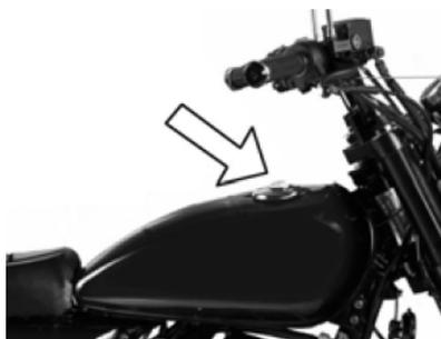
Para abrir a tampa do depósito de combustível rode a chave no sentido dos ponteiros do relógio. A tampa pode então ser removida com a chave. Para voltar a colocar a tampa, alinhe as setas sobre a tampa e o depósito, respetivamente e depois, com a tecla pressionada, pressionar a tampa até encaixar. Em seguida, remova a chave.
