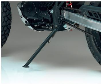
O veículo está equipado com um descanso lateral do lado esquerdo. Para imobilizar o veículo com o auxílio do descanso lateral, pressione a extremidade do mesmo com o pé para o trazer o mais próximo possível da frente do motociclo.
