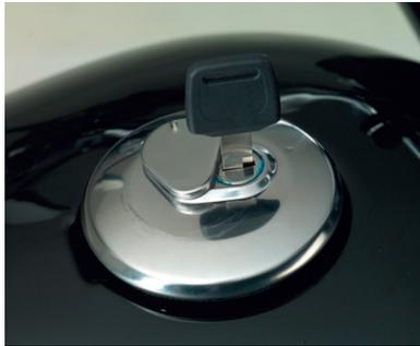
Para abrir a tampa do depósito de combustível rode a chave no sentido dos ponteiros do relógio. A tampa pode então ser removida com a chave. Para voltar a colocar a tampa, alinhe as setas sobre a tampa e o depósito, respetivamente e depois, com a tecla pressionada, pressionar a tampa até encaixar. Em seguida, remova a chave.
